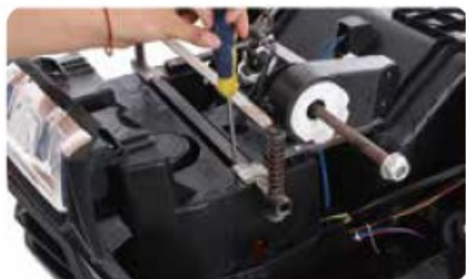
3. Strângeți șurubul pentru a fixa cadrul
